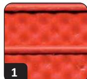
Capa externa fabricada en caucho sintético
