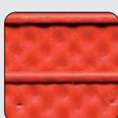
Fabricada en caucho o termocaucho sintético especialmente formulado. En determinados modelos esta capa externa puede estar compuesta por una segunda pared fabricada en polietileno clorosulfonado.
