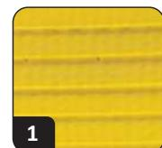
Capa exterior fabricada en hypalón
